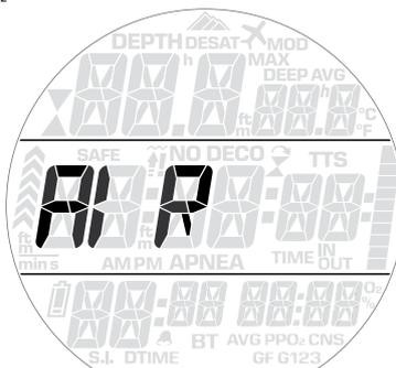
Selezionando **NITROX**, si accede a un sottomenù in cui è possibile definire la percentuale di ossigeno della miscela (O<sub>2</sub>%) e il valore massimo della pressione parziale di ossigeno (ppO<sub>2</sub>max) per tre miscele di respirazione. Il valore massimo possibile per la ppO<sub>2</sub>max è 1,6 bar. La maggior parte delle agenzie didattiche consiglia di non superare il valore di 1,4 bar.
